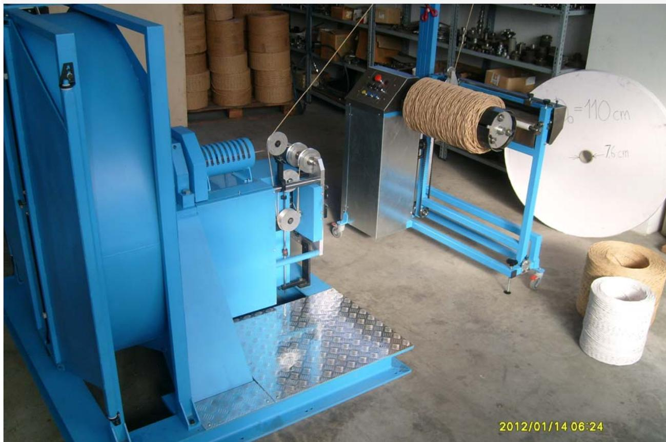
Foto della M09: a sinistra la Unità di Cordatura, a destra la Unità Roccatura.
